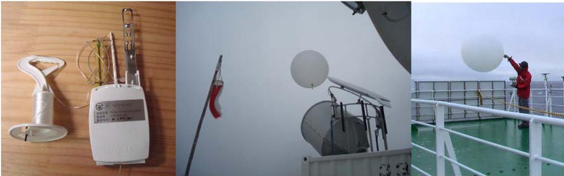
図-6 ラジオゾンデ測器(左) 自動放球場面 (中央) 手放球場面 (右)
