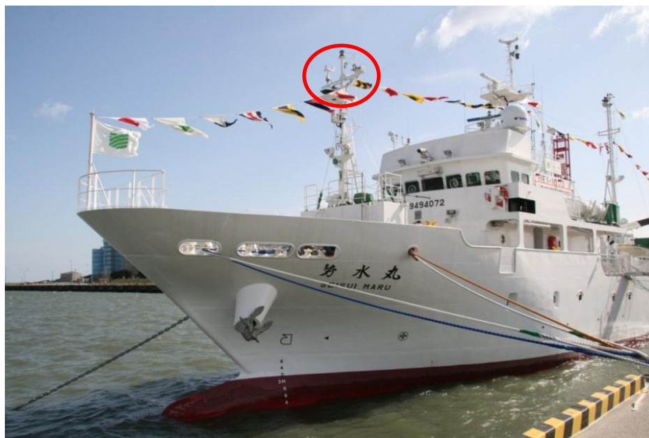
Fig. 1-4 2009年1月にリニューアルした「新」勢水丸. 海面から9mのフォアマストに超音波風速計が常設された. ある地方大学長顧問のつばやき ( http://www.mie-u.ac.jp/blog/2009/03/post-153.html )より引用.
