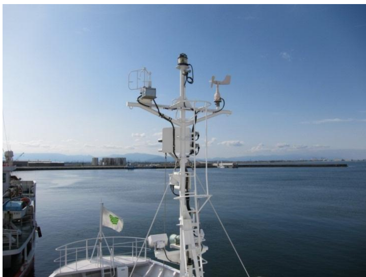
Fig. 2-2 ブリッジ（操舵室）から見た勢水丸のフォアマスト（海面から9m）。右側が風速計で、左側が超音波風速計である。著者撮影（2011年5月7日，松阪港にて）。
