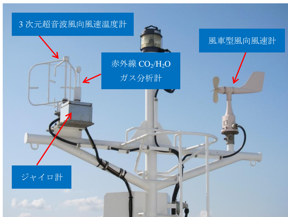
Fig. 2-3 勢水丸に常設された自動気象観測装置。著者撮影（2011年5月7日，松阪港にて）。
